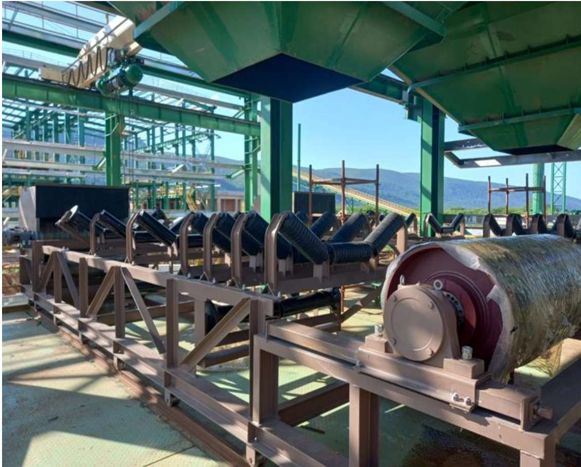
RODILLOS DE CINTA TRANSPORTADORA EN EL TALLER DE MEDIOS Y FINOS
