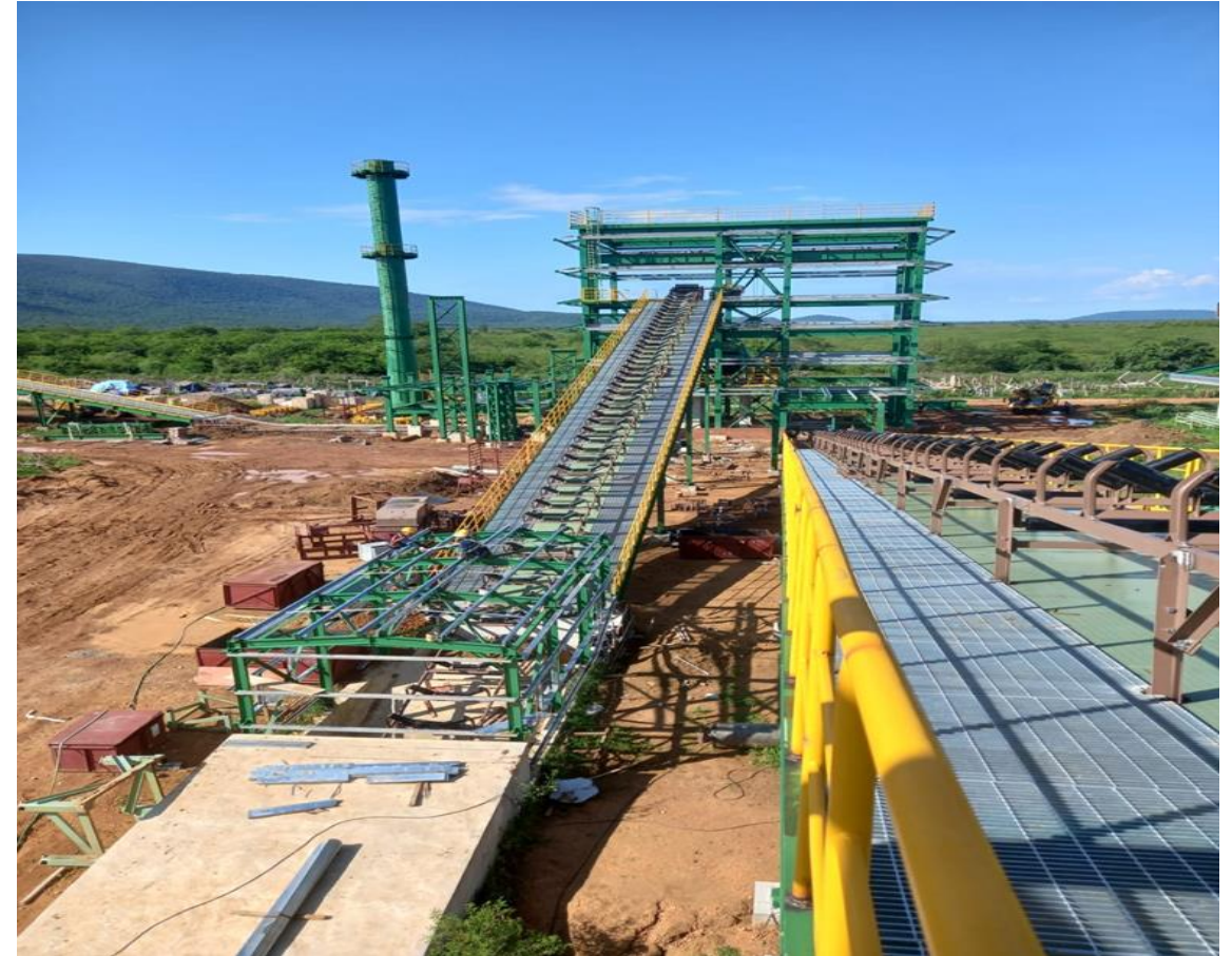
CINTA TRANSPORTADORA DEL TALLER DE MEDIOS Y FINOS AL TALLER DE CRIBADO Y EL RETORNO PARA EL REPROCESADO DEL MATERIAL
